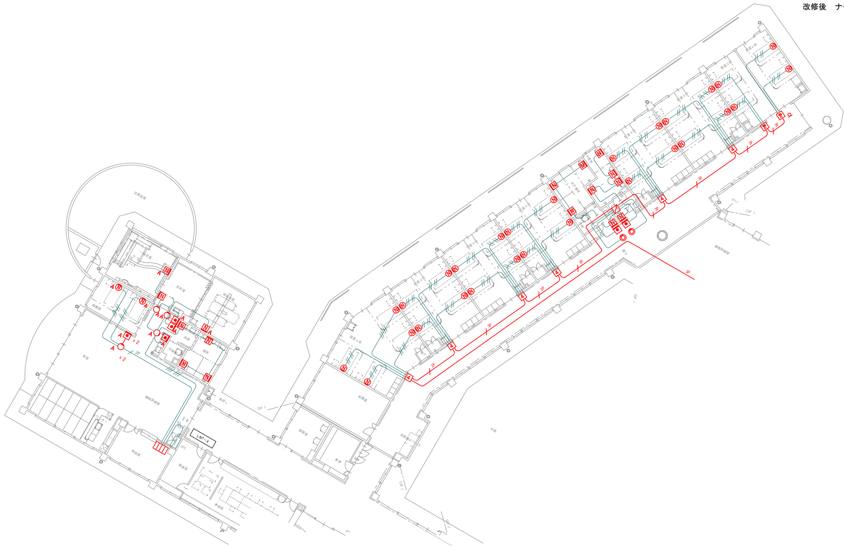
改修後 ナースコール設備 分割-2
